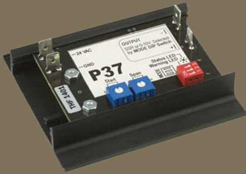
Le contrôleur P37 est un capteur électronique pneumatique pouvant convertir un signal d'entrée de 2-13 PSI à un signal de sortie pulsée ou proportionnel 0 - 10 VDC. Ce contrôleur remplace le P35 et le P36. Par défaut, le contrôleur P37 est programmé pour un signal d'entrée 3 - 8 PSI et une sortie pulsée ajustable à partir des commutateurs DIP en mode action directe ou inverse. Le signal d'entrée peut être ajuster à l'aide d'un manomètre et du bon ajustement des commutateurs DIP.
