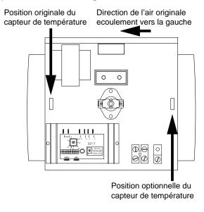
Dans la partie inférieure du tableau (à partir du FORMAT C) le boîtier devient plus grand et le serpentin est divisé en deux parties, pré-chauffage et chauffage, chacune alimentée par son propre contrôleur et équipée de ses propres protections.
